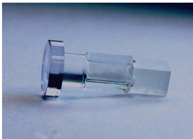
Cavité laser composite hybride monolithique (Oxxius)
