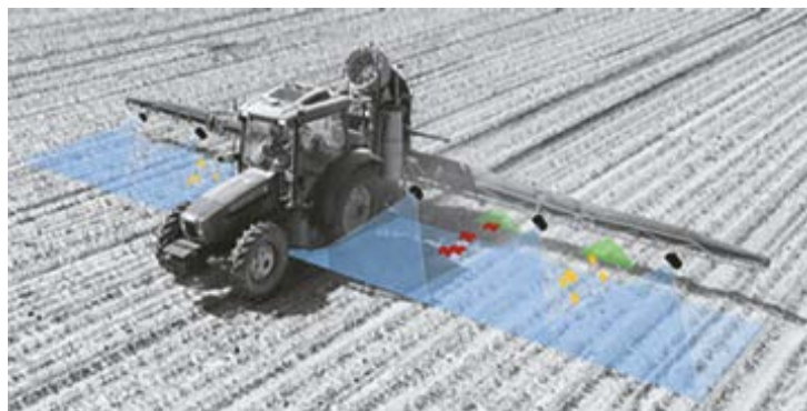
Exemple d'intégration de capteurs sur rampe pour pilotage de pulvérisation selon la flore adventices
