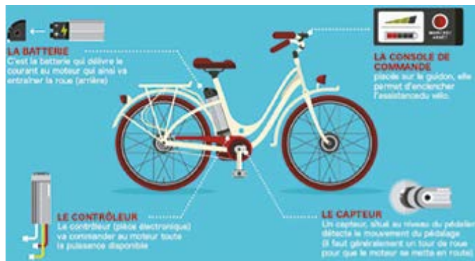
Composants électriques de vélo à assistance électrique
